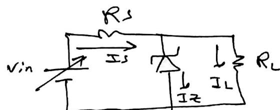
$$\rightarrow V_{in(\max)} = I_{S_{\max}} R_S + V_L = I_{S_{\max}} R_S + (I_L R_L + V_Z) = (I_{Z\max} + I_L) R_S + V_Z$$
